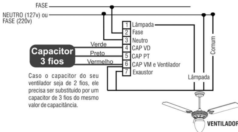
Caso o capacitor do seu ventilador seja de 2 fios, ele precisa ser substituído por um capacitor de 3 fios do mesmo valor de capacitância.
